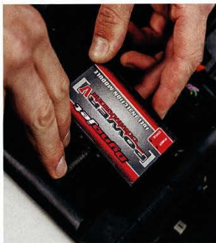
Unter der Sitzbank schlummert die Elektronikpracht der Victory und bittet um einen Powercommander. Dessen Konfiguration sollte aber ein Fachmann übernehmen
